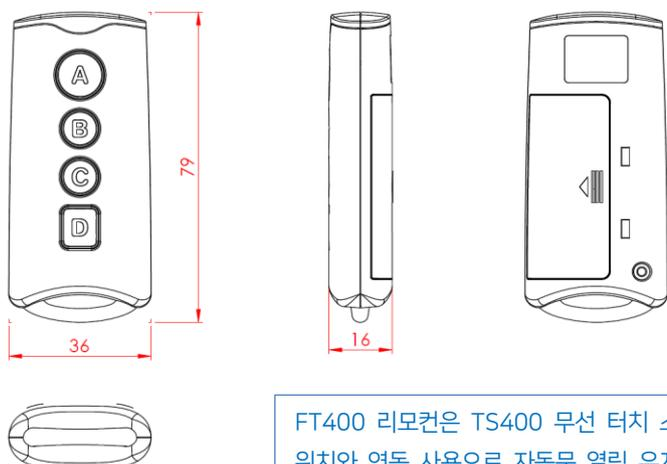
FT400 리모컨은 TS400 무선 터치 스위치와 연동 사용으로 자동문 열림 유지 및 잠금 설정이 가능합니다.
